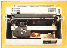
La stampante senza il ripetibile. Mostra, dall'alto, l'area di stampa e si scende fino a pochi centimetri le grandi spazzole di stampa. Il rasoio è in basso.
